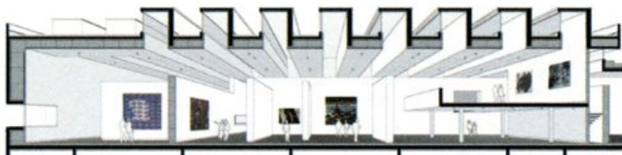
Plans en coupe et croquis des sheds, réalisés par Jacques Ripault.
